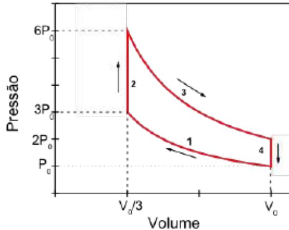
(b) Usaremos a convenção de que trabalho realizado *pelo* gás e calor *injetado* no gás são positivos. Nesse caso,  $\Delta U = Q - W$ . A energia interna de um gás ideal só depende da sua temperatura. Como não há variação de temperatura no processo 1, a variação da energia interna é nula  $\Delta U_1 = 0$ . No processo 2 o trabalho é nulo, pois não há variação de volume. A variação de energia interna é, portanto, igual ao calor injetado no sistema (note que  $n = 1$ )
