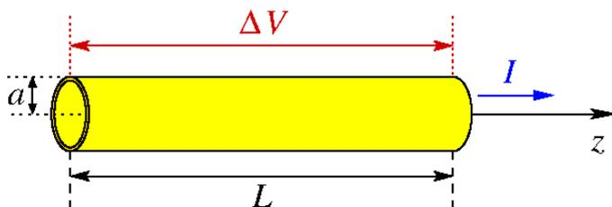
Um pedaço de fio, com resistividade  $\rho$ , seção transversal circular de raio  $a$  e comprimento  $L$ , é submetido a uma diferença de potencial  $\Delta V$ , fazendo surgir uma corrente  $I$  tal como ilustra a figura acima.
